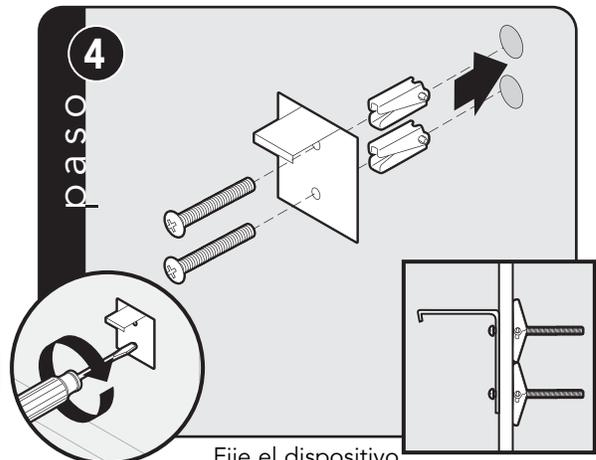
Fije el dispositivo con los tornillos que se proporcionan.
