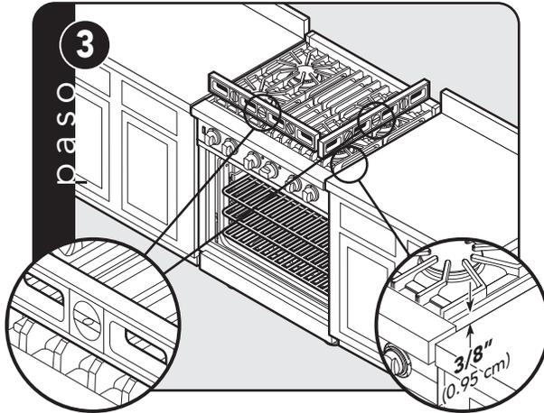
Verifique que la unidad está nivelada de lado a lado y de atrás al frente. La moldura lateral debe estar a 3/8" (.95 cm) sobre la superficie de los gabinetes adyacentes. Si la unidad no está nivelada, repita los pasos 5 al 7 de la sección "Nivelación/Ajuste/ Alineamiento".
