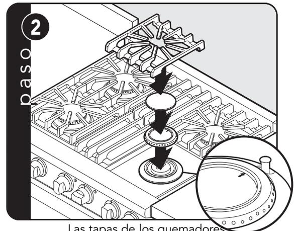
Las tapas de los quemadores están empacadas en poliestireno con las parrillas. Coloque los quemadores en la superficie de la estufa. Coloque las parrillas de los quemadores encima de las tapas de los quemadores y de los soportes de las parrillas. **Nota:** La flecha que se encuentra en la tapa del quemador debe estar apuntando hacia la parte posterior de la estufa.
