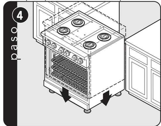
Baje la estufa suavemente para evitar el esfuerzo indebido sobre las patas y el herraje de montaje interno.
