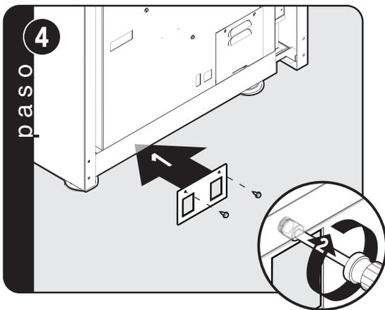
Fije el soporte a la parte posterior de la estufa usando dos tornillos.
