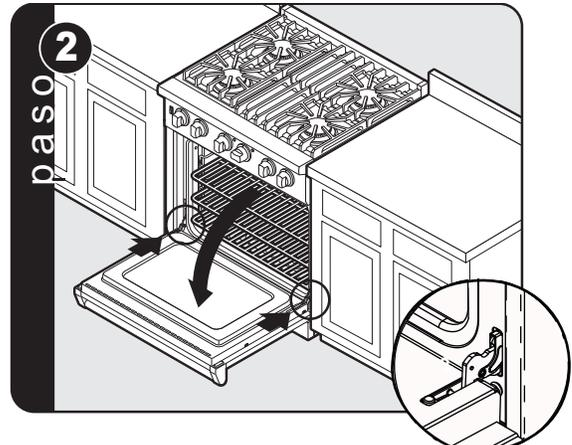
Abra la puerta completamente. Pliegue los pestillos hacia delante hasta que queden fijos en su sitio.
