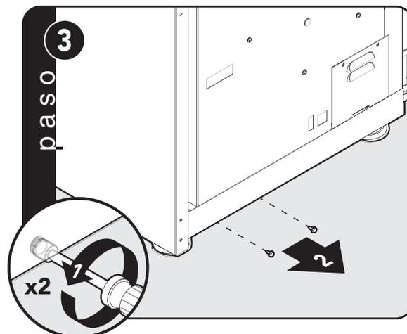
Retire los dos tornillos de la parte posterior de la estufa.
