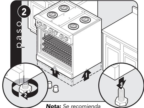
**Nota:** Se recomienda enfáticamente que se use un gato para paletas o un gato elevador en lugar de inclinar la unidad. Eleve la unidad aproximadamente un pie (12 pulg). Destornille las patas provisionales de los acopladores.
