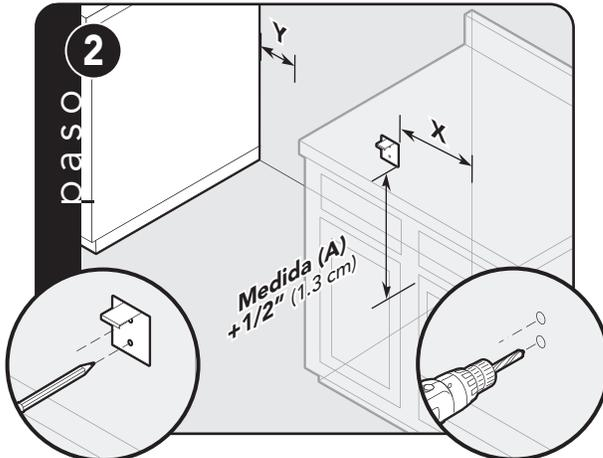
Ponga el dispositivo antivolcaduras en la pared posterior, con la esquina superior izquierda en la medida (A) más 1/2" (1.3 cm) del piso y a "X" (vea la tabla) de donde se va a colocar el lado derecho de la estufa (viendo la estufa de frente), y a "Y" (vea la tabla) de donde se va a colocar el lado izquierdo de la estufa (viendo la estufa de frente).
