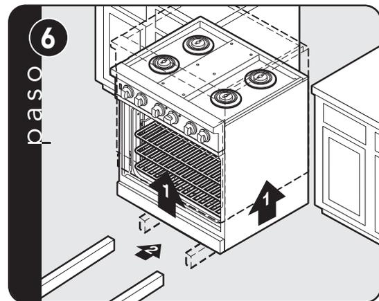
Levante la unidad y coloque debajo dos bloques de madera.
