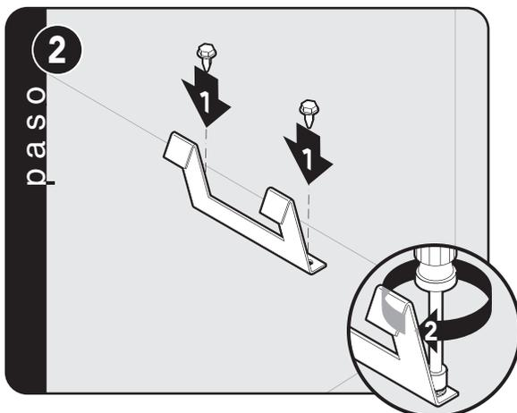
Monte el gancho del soporte estabilizador al piso usando los tornillos provistos.
