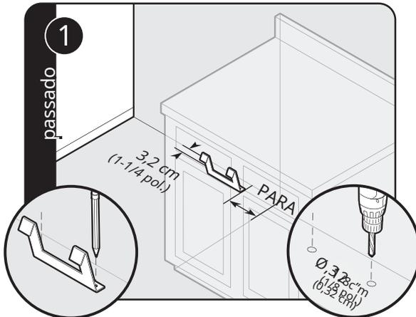
Localize o gancho do suporte anti-queda no piso do gabinete lateral Dim e 1-1/4" da parede traseira ao usar acabamento em ilha ou plataforma alta. Marque e faça furos de 0,32 cm (1/8 pol.) onde o suporte será colocado.
