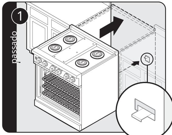
Coloque o fogão no lugar. Certifique-se de que o dispositivo anti-queda encaixe na abertura correspondente.
