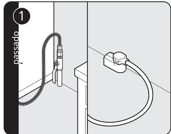
Gás e conexão elétrica. Antes de operar a unidade, sempre verifique se há vazamentos de gás.
