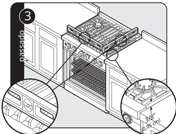
Verifique se a unidade está nivelada de lado a lado e de volta testa. A guarnição lateral deve estar 3/8" (0,95 cm) acima da superfície dos gabinetes adjacentes. Se a unidade não estiver nivelada, repita os passos 5 a 7 na seção "Nivelamento/ Ajuste/ Alinhamento".
