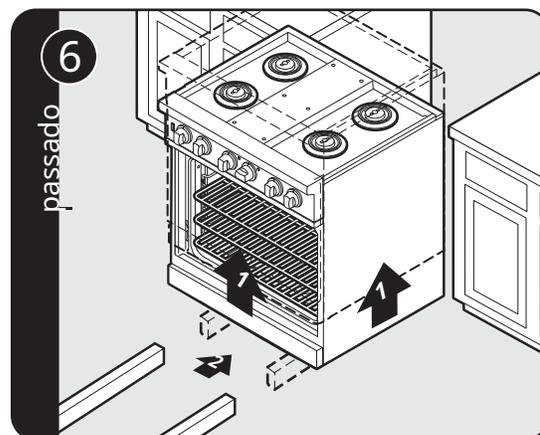
Levante a unidade e coloque dois blocos sob ela de madeira.
