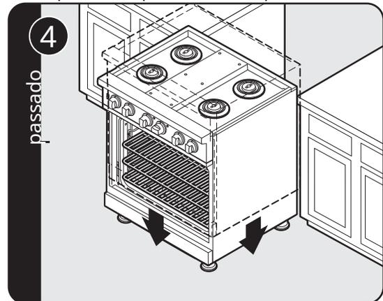
Abaixe a faixa suavemente para evitar estresse indevido nas pernas e no hardware de montagem interno.
