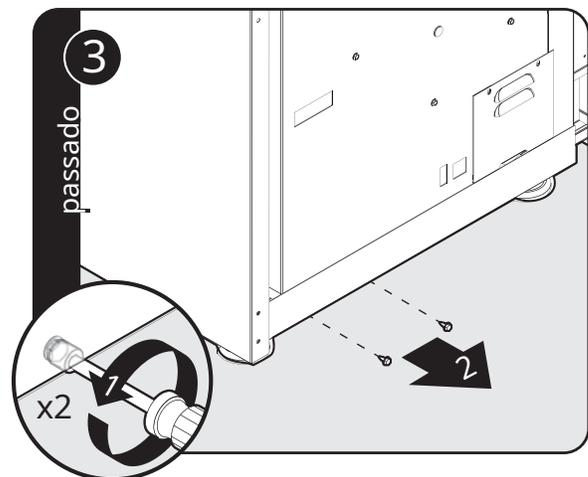
Remova os dois parafusos na parte de trás do forno.
