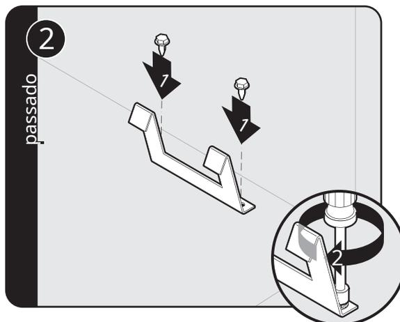
Monte o gancho do suporte do estabilizador no chão usando os parafusos fornecidos.
