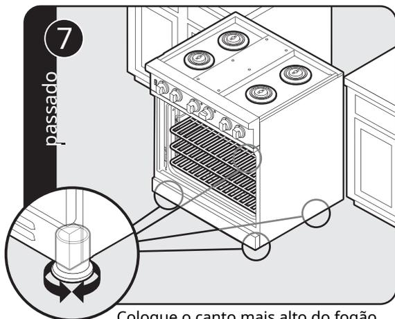
Coloque o canto mais alto do fogão de modo que a parte superior da moldura lateral fique 3/8" (0,95 cm) acima da superfície do gabinete. Nivele o intervalo com o canto mais alto.
