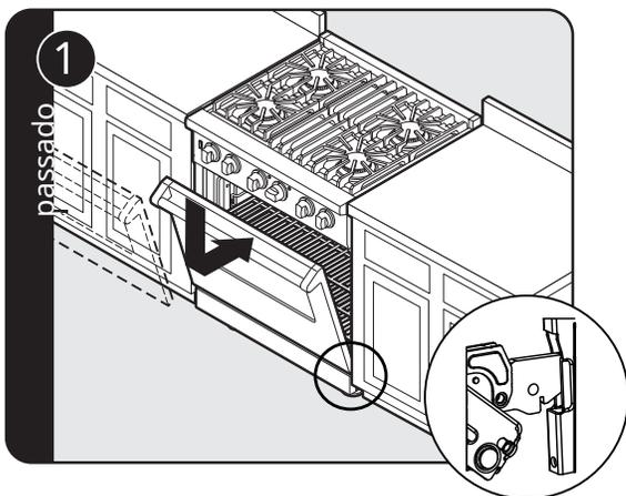
Coloque a porta de volta no fogão.
