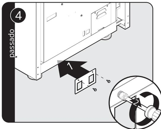
Prenda o suporte na parte de trás do fogão usando dois parafusos.
