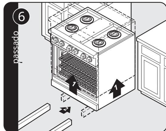
Levante a unidade e coloque dois blocos sob ela de madeira.
