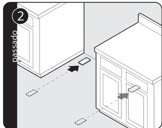
Para pisos irregulares ou inclinados, nivele a unidade usando apenas calços de metal se o ajuste necessário excede o acorde disponível nas pernas.
