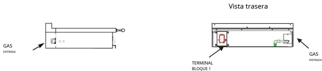
La entrada de gas solo existe en los modelos con al menos un módulo de gas en la encimera o un horno de gas.
