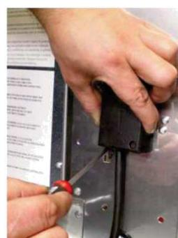
Acceder a la(s) regleta(s) de conexiones a las que se conectan las distintas resistencias (si en la cocina hay 2 ó 3 cables de alimentación, también habrá 2 ó 3 regletas de conexiones).
