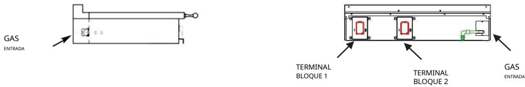
La entrada de gas solo existe en los modelos con al menos un módulo de gas en la encimera o un horno de gas.
