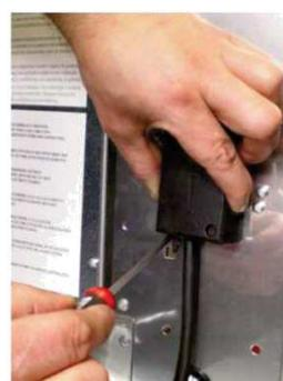
Aceda ao(s) terminal(is) de ligação ao(s) qual(is) estão ligados os vários elementos de aquecimento (se houver 2 ou 3 cabos de alimentação no fogão, haverá também 2 ou 3 bornes de ligação).
