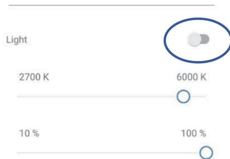
Selezionare la barra di spostamento per stabilire la temperatura di colore (°K).
